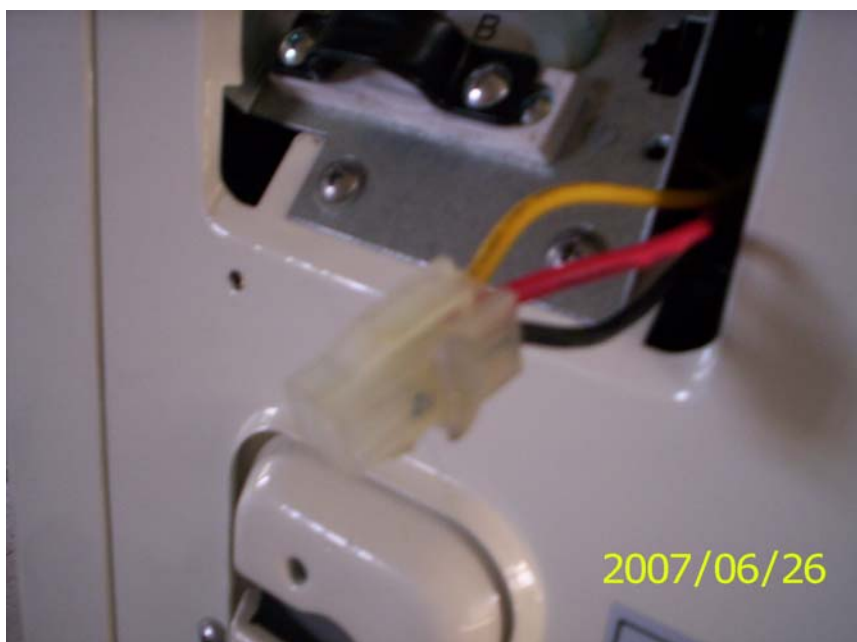
3. ábra: Az aljzat a helyéről kihúzva
